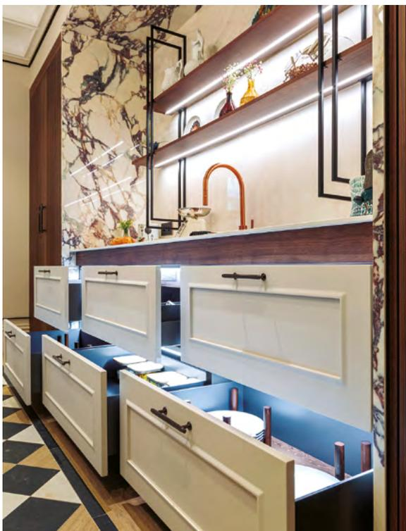
Bc3 también ha implementado la **iluminación interior de cajones y caceroleros** con lámparas LED o perfiles de aluminio adaptados. Las luces se activan automáticamente al abrir el cajón. Esta tecnología permite llevar la iluminación a cualquier compartimento de la cocina, mejorando notablemente la experiencia de uso diario.
