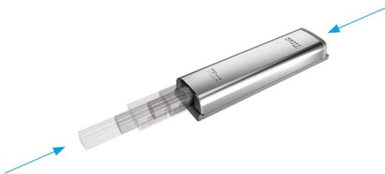
**Push Latch S2:** solución de segunda generación para la apertura táctil sin esfuerzo de armarios sin tiradores. Este sistema proporciona una apertura silenciosa y sin rebotes gracias a la función de amortiguación, así como un cierre seguro de la puerta. Funciona con bisagras estándar, con o sin cierre suave. El ajuste de la separación entre la puerta y el panel lateral asegura la precisión y la fiabilidad de la acción en todas las aplicaciones.
