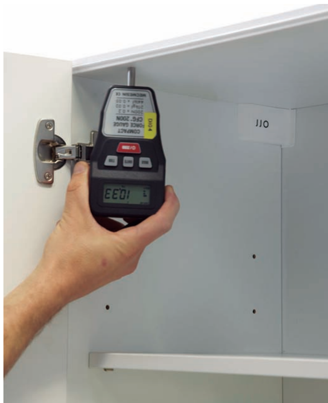
Ensayo de mueble suspendido con colgador antivuelco Scarpi 4 sobre armario de Eco Bathrooms JJO plc (UK). Norma EN 14749.
