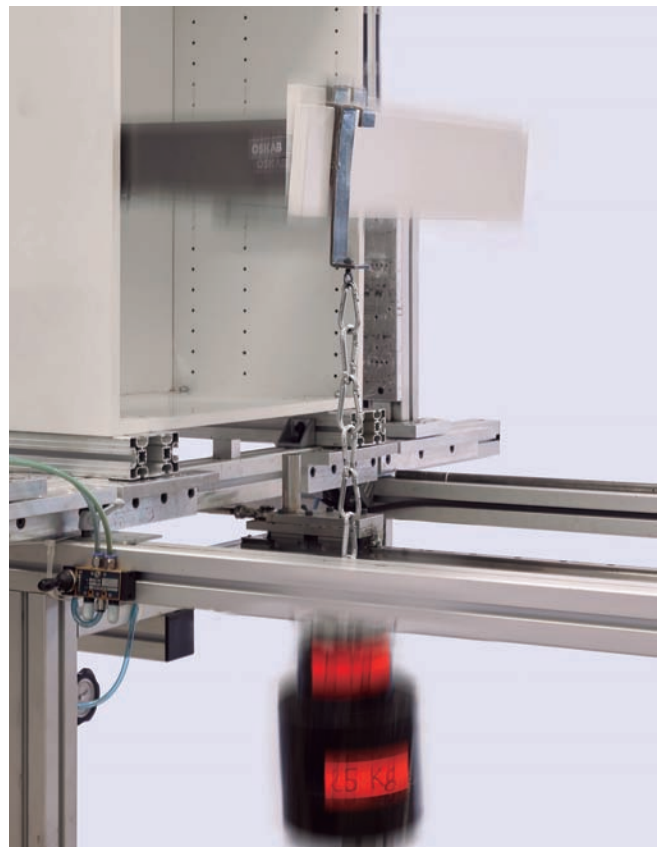
Sobrepeso o carga vertical sobre el cajón Ariane, montado en mueble de Oskab (FR). 30 Kg. Norma EN 15338.
