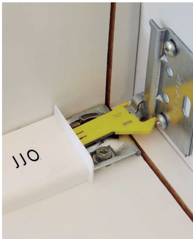
Ensayo de mueble suspendido con colgador antivuelco Scarpi 4 sobre armario de Eco Bathrooms JJO plc (UK). Norma EN 14749.
